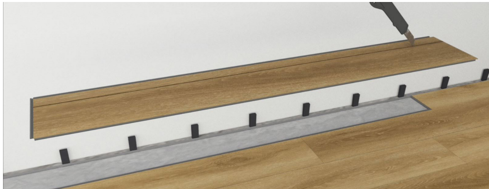
Mida el área sobre la que se va a instalar, el ancho de la última fila no debe ser menor a 50 mm., en caso contrario, ajuste el ancho de la primera fila antes de comenzar la instalación / Measure the area to be installed; the width of the last row should not be less than 50mm. If so, adjust the width of the first row to be installed.
